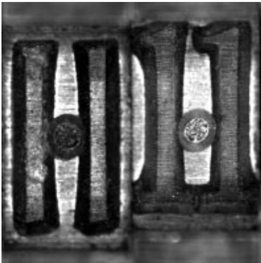
Figura 2: diferents detalls d'un caràcter compost i fos amb plom de la linotípia d'en Lluís Crespo [9]
