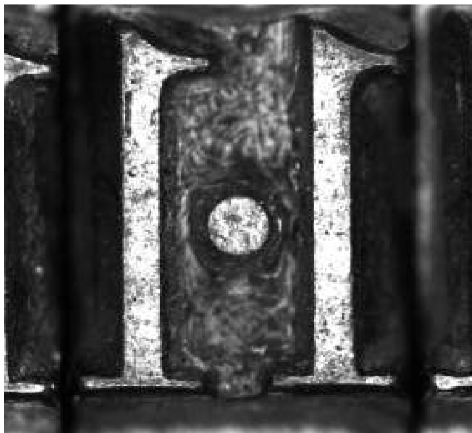
Un tipus mòbil d'ela geminada (d'una sola peça), de metall per compondre manualment. Pertanyia a la impremta C. Casacuberta (l'antiga Editorial Barcino), per gentilesa de Jordi de Casacuberta. / DANIEL RODRÍGUEZ
